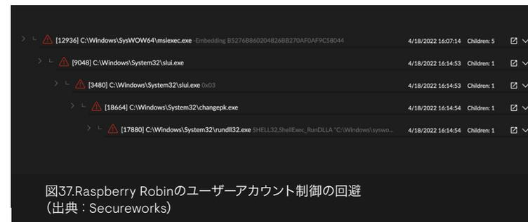
図37.Raspberry Robinのユーザーアカウント制御の回避 (出典：Secureworks)
